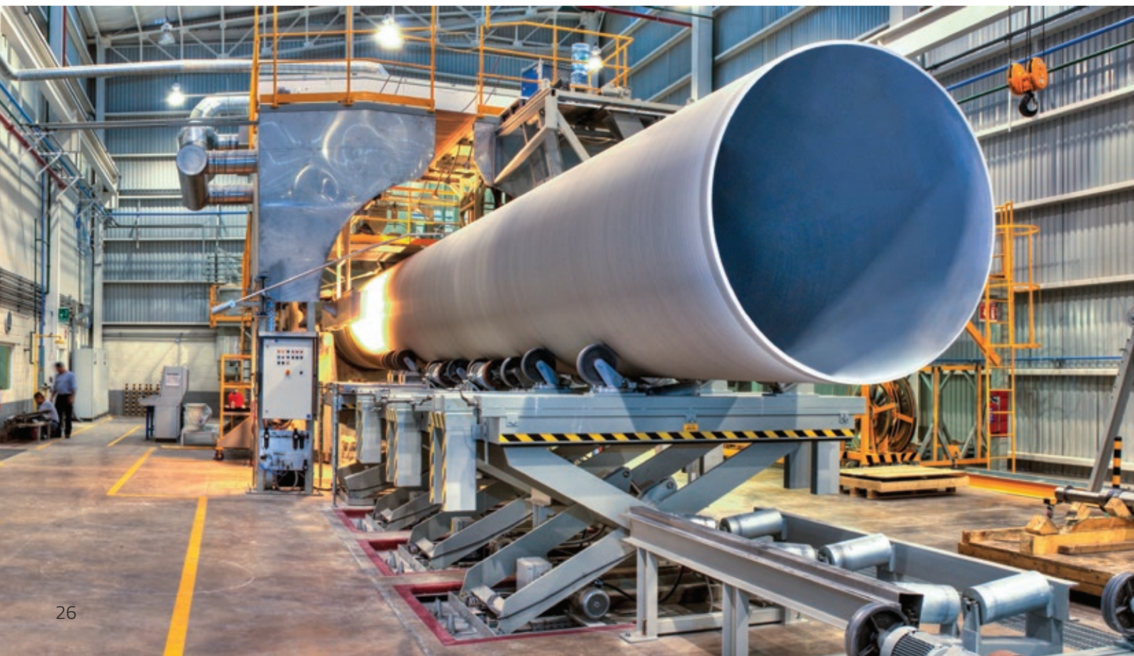
Nepārtrauktas šķiedru uztīšanas process (Flowtite tehnoloģija).
