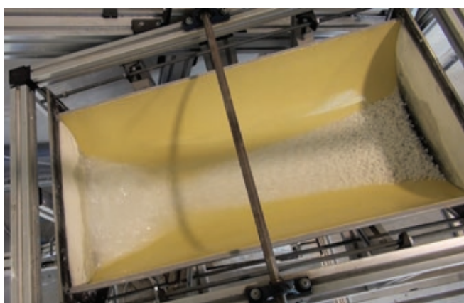
Вверху: испытание на истирание. Внизу: испытание долговременной жесткости.
