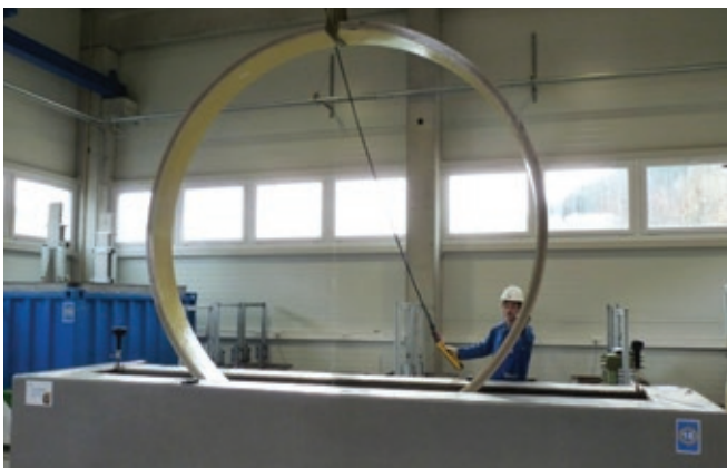
Вверху: испытание на истирание. Внизу: испытание долговременной жесткости.
