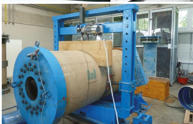
Imágenes, de arriba abajo: Prueba de corrosión por alargamiento unitario a tracción, base de diseño hidrostático (HDB), ensayo de flexión a largo plazo del anillo, pruebas en las uniones.
