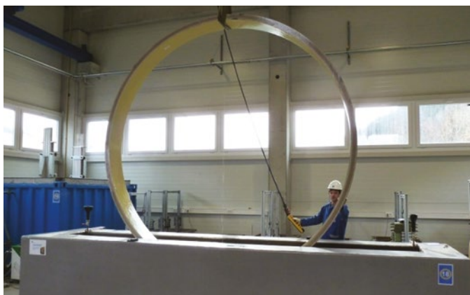
Arriba: Prueba de resistencia a la abrasión. Debajo: Ensayo de rigidez a largo plazo del anillo.
