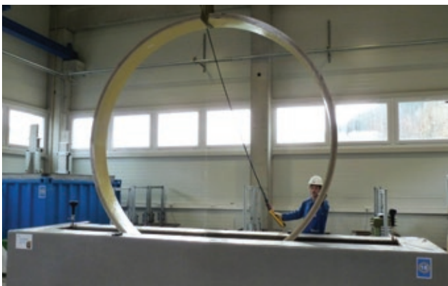
Powyżej: Badanie odporności na ścieranie. Poniżej: badanie sztywności długoterminowej.
