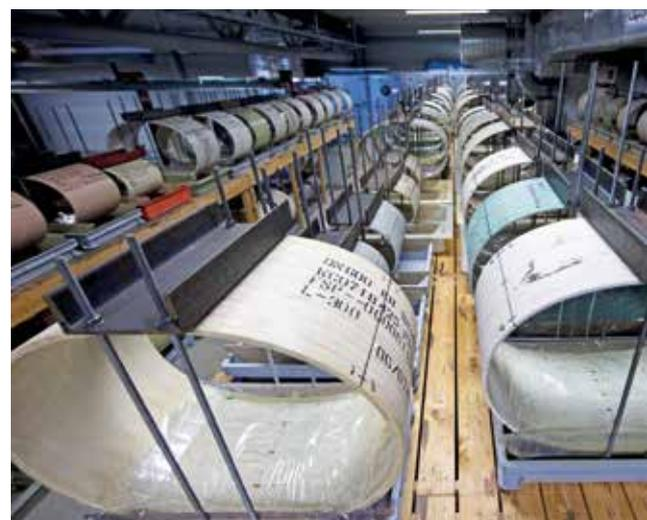
**Abb. 1:** Strain corrosion Tests nach ASTM D3681 im Amiblu R&D Center in Norwegen.
