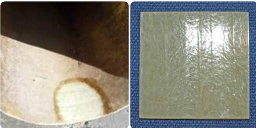
Links: Nachdem das Rohr mit Wasser und Seife gereinigt wurde, sah es brandneu aus. Es gab keine Anzeichen von Alterung. Die Testergebnisse bestätigten den ausgezeichneten Zustand auch in Bezug auf die Leistung des Rohres.
