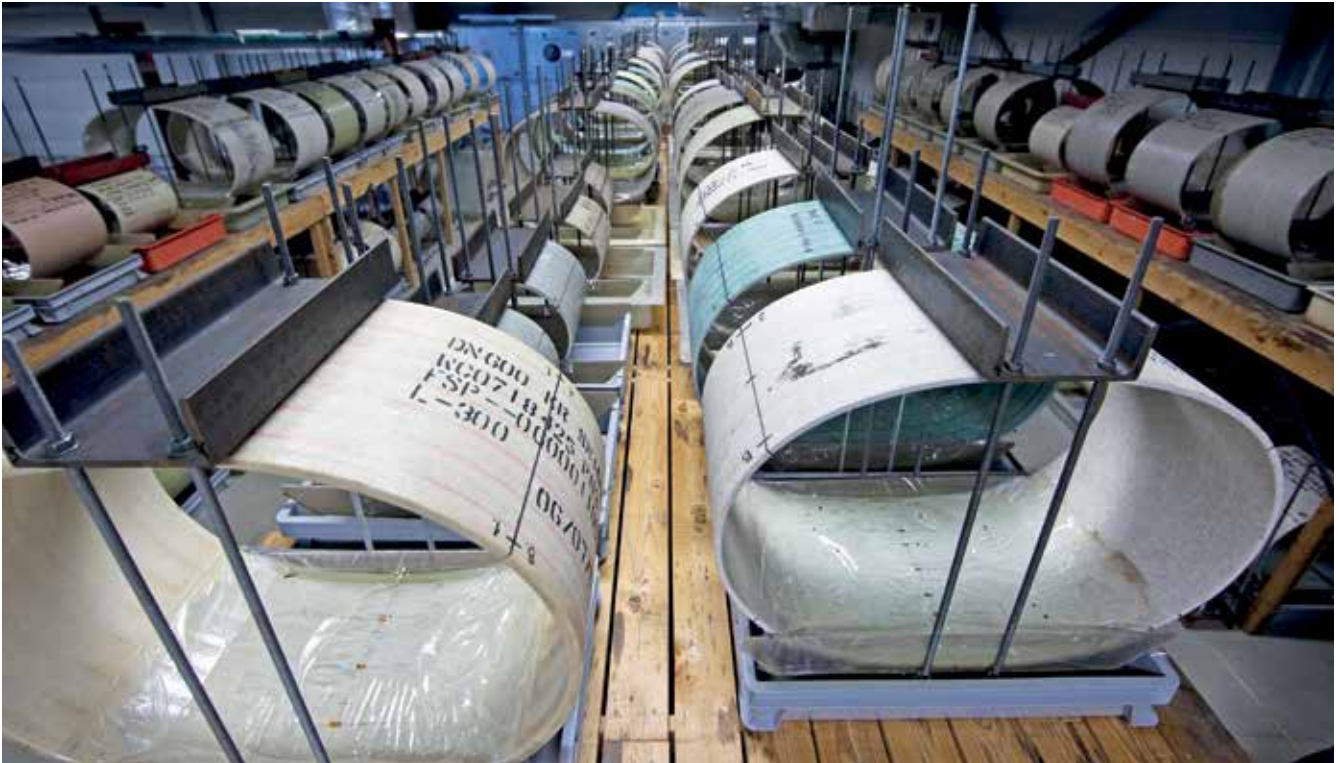
Abb. 1: GFK Langzeit-Korrosionsbeständigkeitstests seit 1978, Amiblu Technology Center in Norwegen
