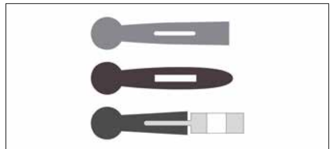
Abb. 41: Querschnitte typischer profilierter Dichtungen
