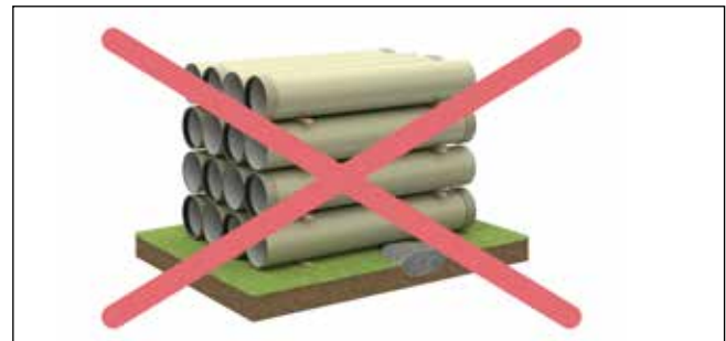
Abb. 9: Rohre dürfen nicht auf Steinen liegen
