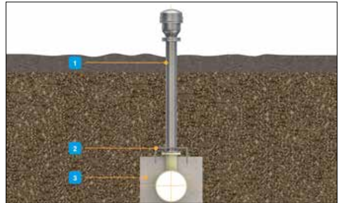
Abb. 82: Stützblock für große Verlegetiefen
