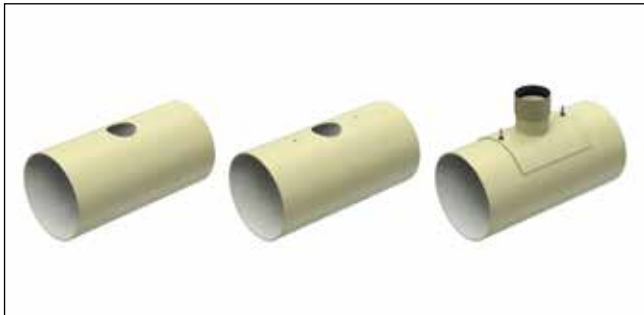
Abb. 69: Montage geschraubter Sättel
