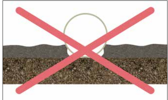
Abb. 14: Unsachgemäße Zwickelverfüllung (Hohlräume sind unzulässig)
