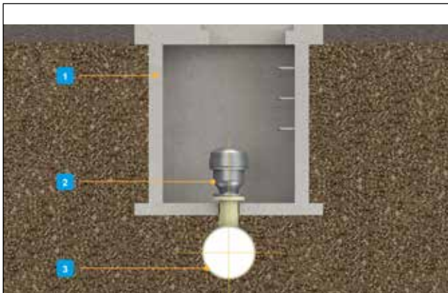
Abb. 81: Unterbringung einer Luft-/Vakuum-Armatur mit kleinem Durchmesser
