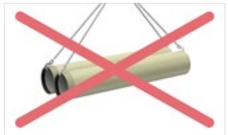
Abb. 3: keine Ketten, Haken und Stahlseile verwenden
