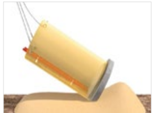
Abb. 26: Aufrichten eines Schachtes mit Seilgehänge
