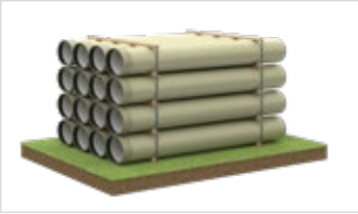
Abb. 9: Richtige Lagerung in der Verpackungseinheit
