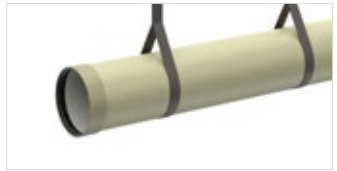
Abb. 2: Be- und Entladen von Rohren mit Hebezeugen
