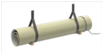
Abb. 4: Anheben verschachtelter Rohre
