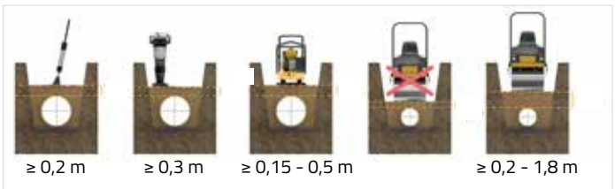
Abb. 16: Mindesthöhe der verschiedenen Verdichtungsgeräte.
