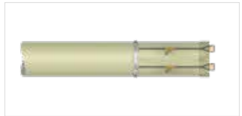
Abb. 20: Montage von losen Kupplungen an Rohren
