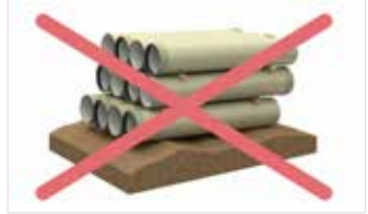
Abb. 10: Rohre dürfen nicht auf unebenen Flächen gelagert werden.
