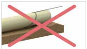
Abb. 8: Rohre dürfen nicht über den Boden geschleift werden
