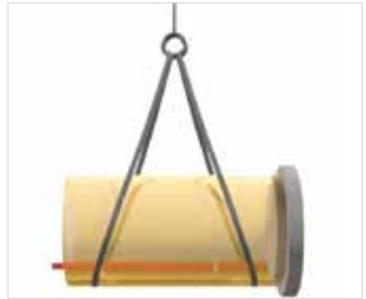
Abb. 22: Handhabung eines liegenden Gerinneschachtes
