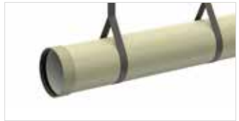
Abb. 2: Be- und Entladen von Rohren mit Hebezeugen
