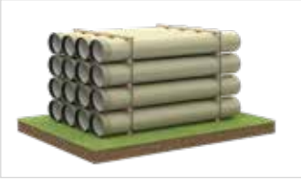
Abb. 9: Richtige Lagerung in der Verpackungseinheit
