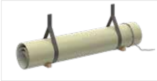
Abb. 4: Anheben verschachtelter Rohre
