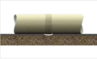
Abb. 12: Rohrverlegung mit Vertiefung auf der vorbereiteten Bettungsschicht
