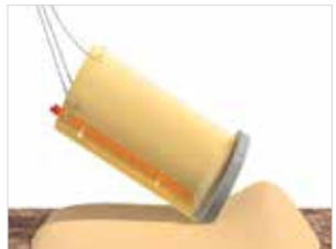
Abb. 26: Aufrichten eines Schachtes mit Seilgehänge
