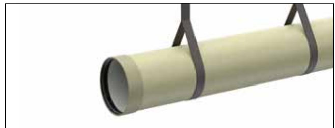
Abb. 2: Be- und Entladen von Rohren mit 2 Hebezeugen
