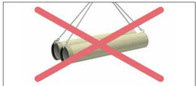
Abb. 3: Haken und Drahtseile dürfen für den Transport nicht in direktem Kontakt mit dem Rohr verwendet werden
