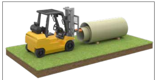
Abb. 5: Entfernen von Rohren aus der Verschachtelung mit geschützten Gabeln
