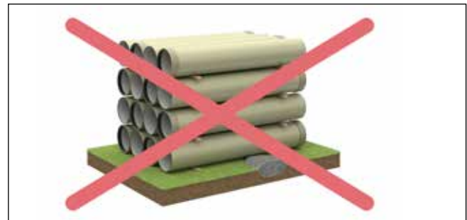
Abb. 9: Rohre dürfen nicht auf Steinen liegen
