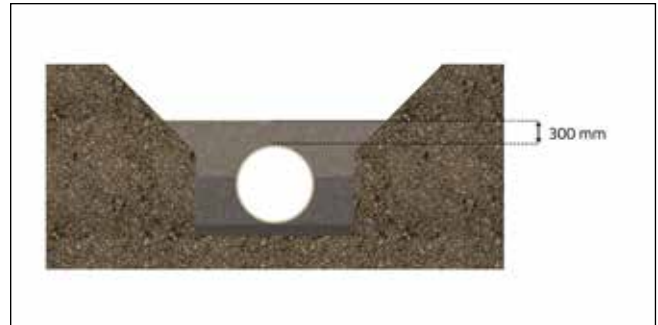
Abb. 74: Ausgraben zu stark durchgebogener Rohre
