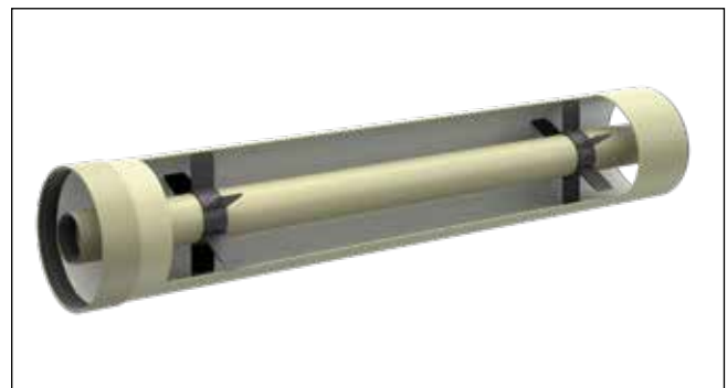
Abb. 62: Rohr-in-Rohr-System mit Mantelrohr und Abstandhaltern
