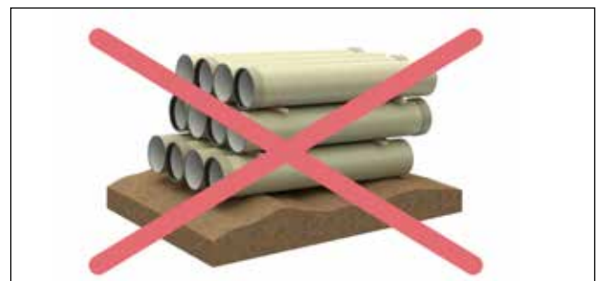
Abb. 10: Rohre dürfen nicht auf einer unebenen Oberfläche liegen
