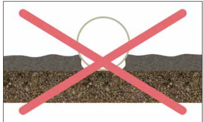
Abb. 14: Unsachgemäße Zwickelverfüllung (Hohlräume sind unzulässig)
