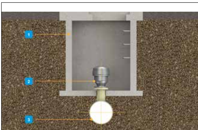
Abb. 82: Unterbringung einer Luft-/Vakuump-Armatur mit kleinem Durchmesser
