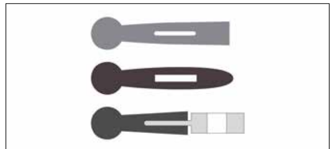
Abb. 42: Querschnitte typischer profilierter Dichtungen
