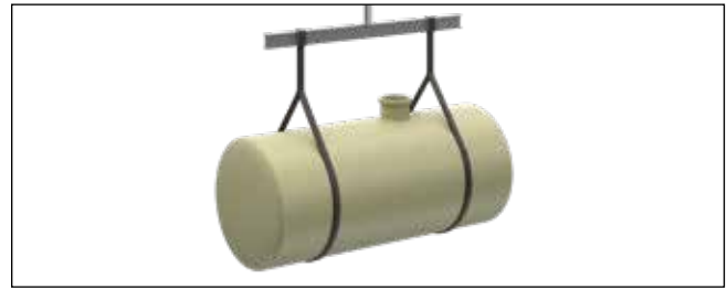
Abb. 6: Handhabung von GFK-Formstücken
