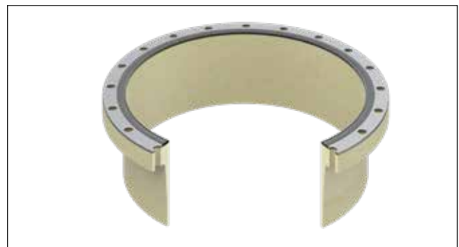
Abb. 40: Profilierte vollflächige Dichtung mit Stützring (gilt als Kraft-Hauptschluss Dichtungssystem „flat face gasket“)
