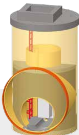
Drosselschacht mit nass aufgestellter Drossel
