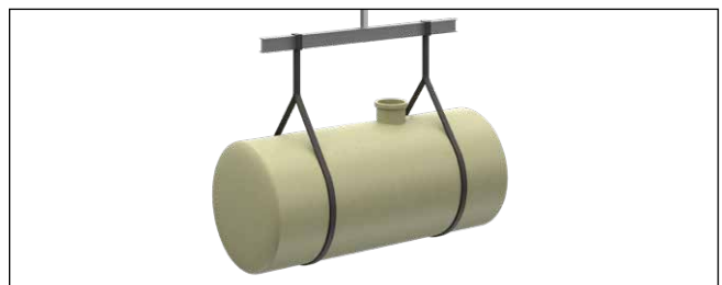
Рис. 6: Поводження зі склопластиковим фітінгом
