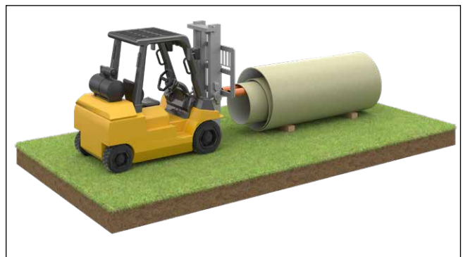
Рис. 5: Розпакування труб захисними вилами
