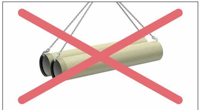
Рис. 3: Гаки та канати не можна використовувати для транспортування в безпосередньому контакті з трубою
