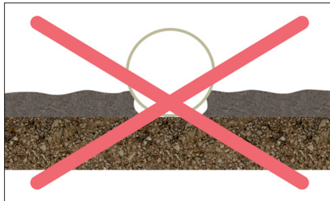
Fig. 14: Forkert tilfyldning af udjævningslag
