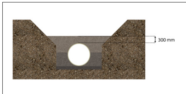
Fig. 73: Udgravning af rør med overdefleksion
