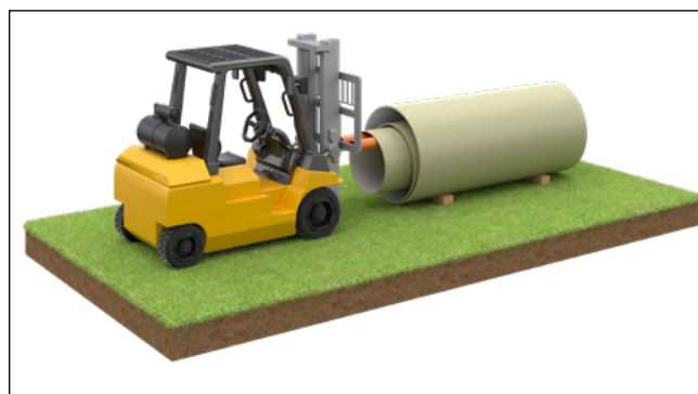
Fig. 5: Fjernelse af teleskoperede rør med beskyttede gafler
