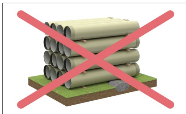
Rys. 8: Nie należy kłaść rur na kamieniach
