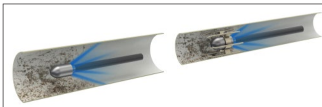
Rys. 74: Czyszczenie strumieniem wody pod wysokim ciśnieniem
