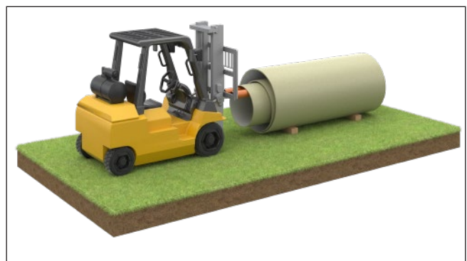
Rys. 5: Wyjmowanie rur za pomocą wózka z zabezpieczonymi widłami
