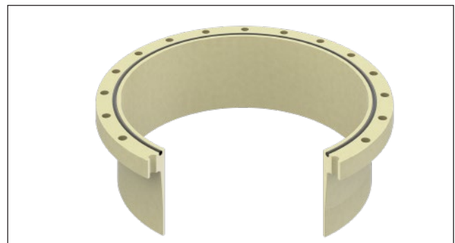
Rys. 40: Uszczelka O-ring (przy ustalaniu momentu dokręcenia traktowana jako przyłąką płaska)
