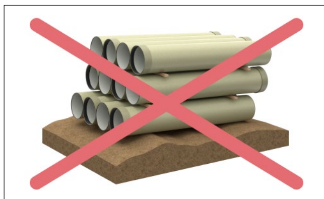
Rys. 9: Nie należy kłaść rur na nierównej powierzchni
