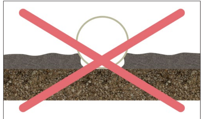
Rys. 14: Nieprawidłowe wypełnienie pachwin rurociągu
