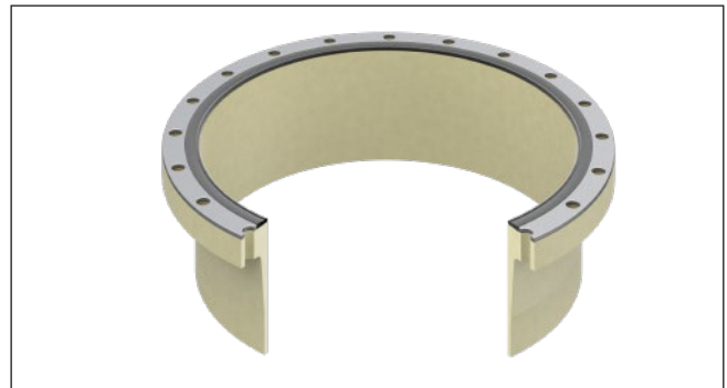
Rys. 39: Profilowana uszczelka z całkowicie podniesioną przyłąką oraz pierścieniem nośnym (przy ustalaniu momentu dokręcenia traktowana jako przyłąką płaska)
