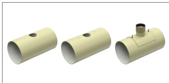
Rys. 69: Montaż siodła śrubowanego
