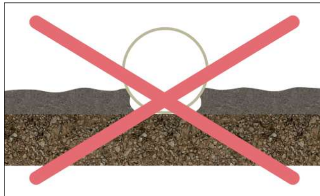
Fig. 14: Preenchimento incorreto da zona de apoio
