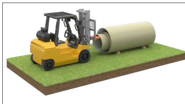
Fig. 5: Remoção de tubos com garfos protegidos
