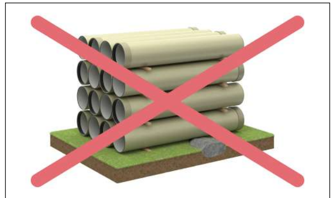
Fig. 8: Os tubos não devem assentar em pedras
