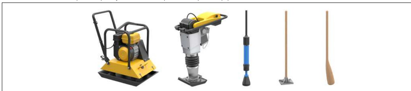
Fig. 19: Equipamentos de compactação operados manualmente
