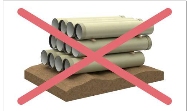
Fig. 9: Os tubos não devem assentar numa superfície irregular
