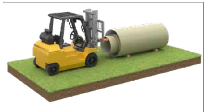
Fig. 5: Desanidado de tuberías con horquillas protegidas
