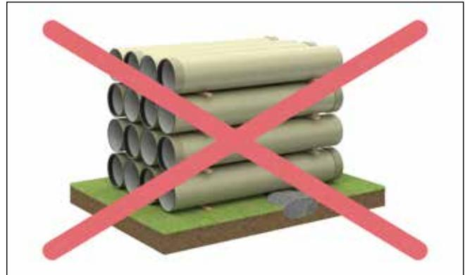
Fig. 8: Las tuberías no deben descansar sobre piedras
