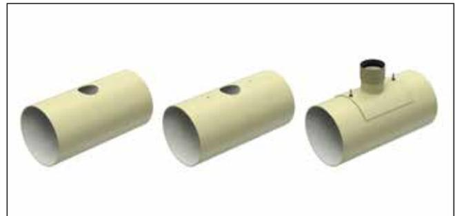
Fig. 69: Montaje de derivaciones atornilladas
