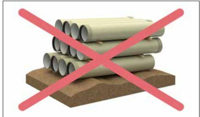
Fig. 9: Las tuberías no deben descansar sobre una superficie irregular
