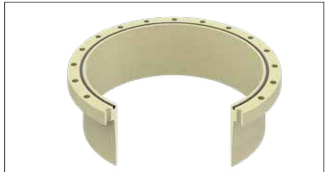
Fig. 40: Junta tórica (considerada integral en toda la superficie para par de apriete)
