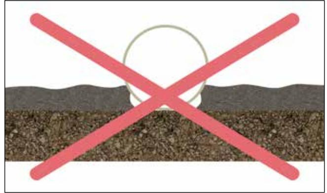
Fig. 14: Relleno de apoyo inadecuado
