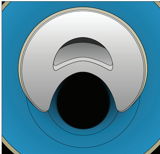
Rys. 60: Naprawa rury bocznej przy użyciu systemu kapeluszowego ("Hat Profile") LCR
