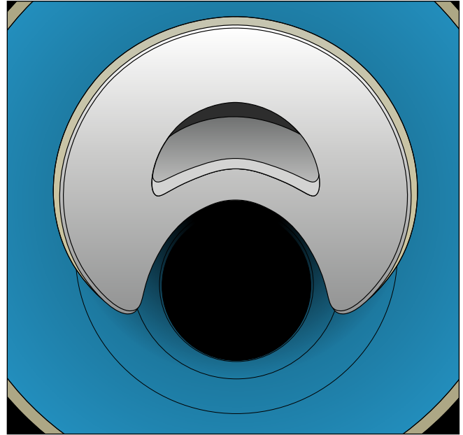
Abb. 60: Zulauf Reparatur mit "Hutprofil"
