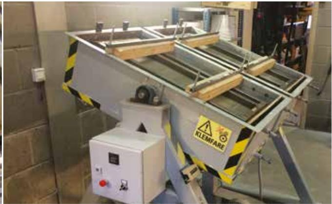
Oben: Darmstadt Rocker Test (Abrasionsbeständigkeit). Unten: Langzeit-Ringsteifigkeitstest.
