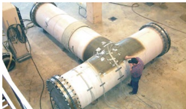
Badania połączenia z laminatu trójnika ciśnieniowego DN1200/1200, PN6.
