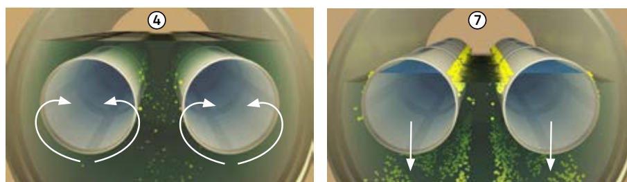
Almacenamiento en PPRV con sistema de retención de sólidos Amiscreen de Amiblu
