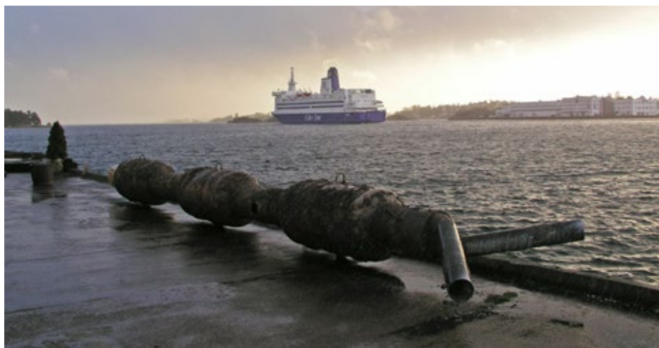
Rys. 12-13: W 2008 roku, po 33 latach kontaktu z oczyszczonymi ściekami i morską wodą, wydobyto na brzeg odcinek rury Flowtite GRP w celu zbadania jej stanu i właściwości mechanicznych. Po częściowym wyczyszczeniu rura wyglądała niemal jak nowa. Nie wykazywała żadnych widocznych oznak zużycia, a jej właściwości mechaniczne pozostały praktycznie niezmienione.
