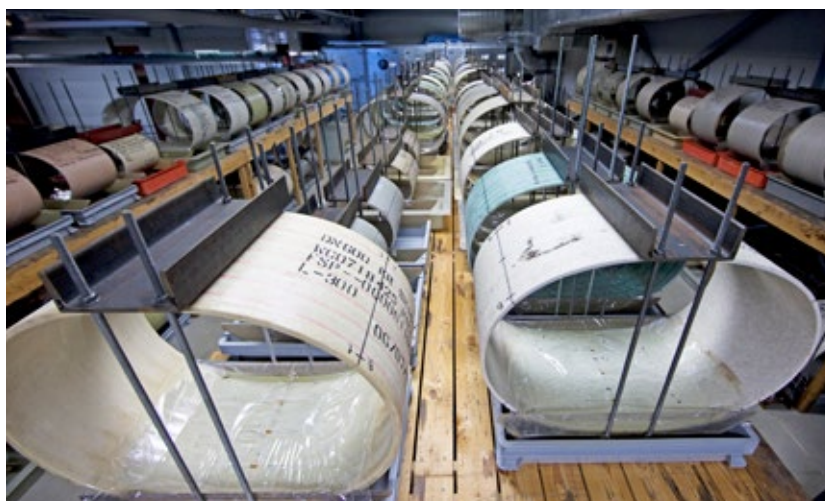
Rys. 4: Testy badające korozję naprężeniową zgodnie z normą ASTM D3681 w centrum badawczo-rozwojowym Amiblu w Norwegii.
