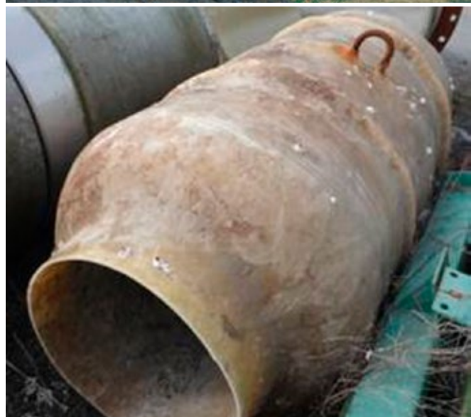
Powyżej: Po 33 latach eksploatacji w wodzie morskiej wydobyto na brzeg odcinek dyfuzora z rur GRP w celu zbadania jego właściwości mechanicznych. Poniżej: Rysunek całego dyfuzora o długości 67 metrów.
