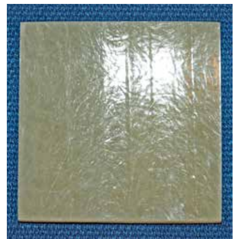
Abb. 12-13: Nach 33 Jahren Belastung durch Abwasser und Meerwasser wurde ein Flowtite GFK-Diffusor zur Analyse seines Zustands und seiner mechanischen Eigenschaften an Land gebracht (links). Nach der Reinigung von Teilen davon sah das Rohr fast wie neu aus (rechts). Das Rohr zeigte keine sichtbaren Anzeichen von Alterung und seine mechanischen Eigenschaften waren im Wesentlichen unverändert. Mehr über dieses Projekt erfahren Sie auf den Seiten 10-11.
