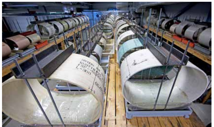
Abb. 4: Strain corrosion Tests nach ASTM D3681 im Amiblu R&D Center in Norwegen.
