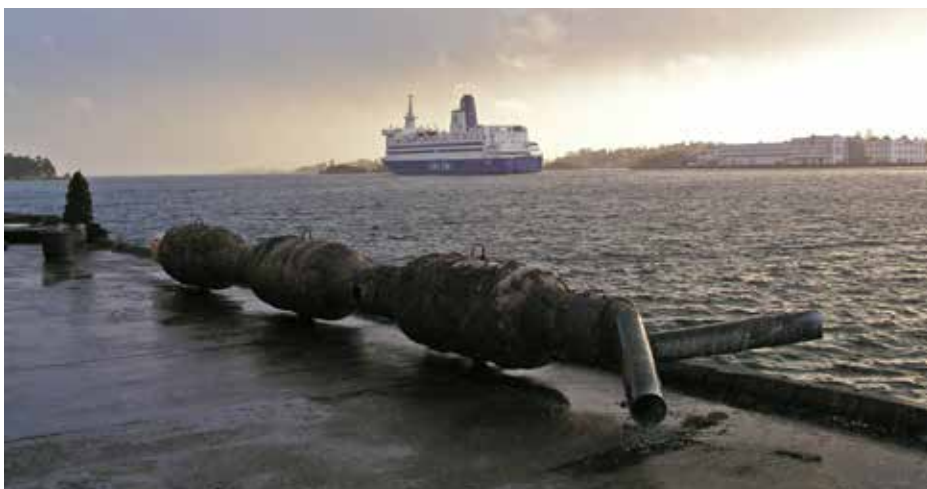
Abb. 12-13: Nach 33 Jahren Belastung durch Abwasser und Meerwasser wurde ein Flowtite GFK-Diffusor zur Analyse seines Zustands und seiner mechanischen Eigenschaften an Land gebracht (links). Nach der Reinigung von Teilen davon sah das Rohr fast wie neu aus (rechts). Das Rohr zeigte keine sichtbaren Anzeichen von Alterung und seine mechanischen Eigenschaften waren im Wesentlichen unverändert. Mehr über dieses Projekt erfahren Sie auf den Seiten 10-11.
