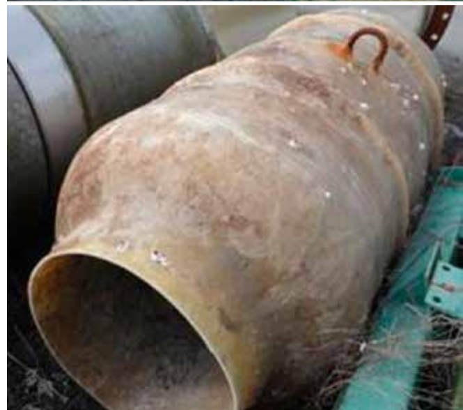
Oben: Nach 33 Jahren Einsatz in Meerwasser wurde ein Teil des GFK-Diffusors an Land gebracht, um seine mechanischen Eigenschaften testen zu lassen.
