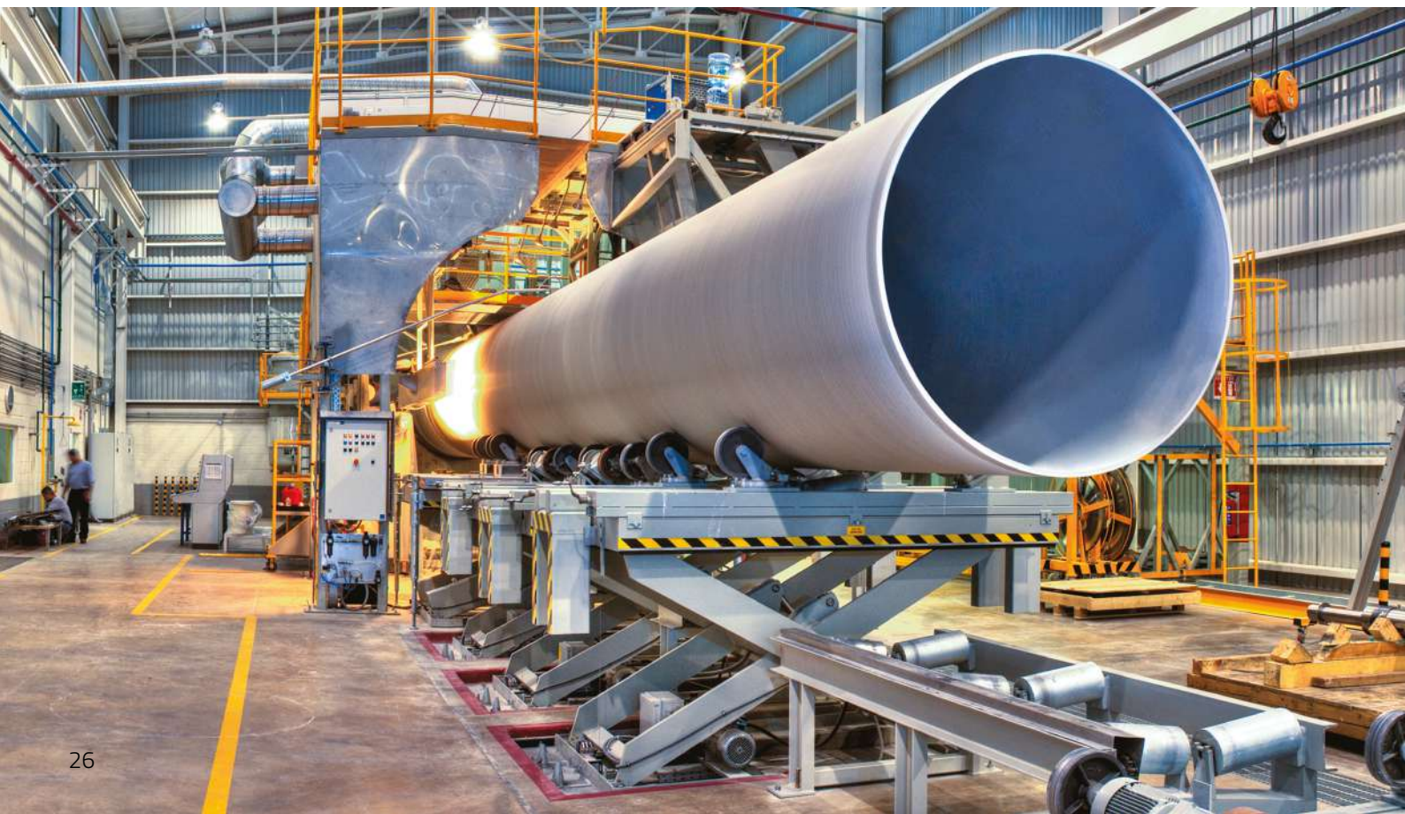
Tubo Flowtite produzido por enrolamento por filamentos contínuo.
