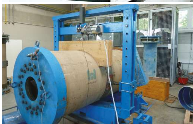
Figuras de cima para baixo: Ensaios de corrosão por deformação, base de conceção hidrostática (HDB), ensaio de flexão de anel a longo prazo, ensaios de juntas.
