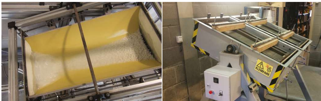
Acima: Ensaio de resistência à abrasão. Abaixo: Teste de rigidez circunferencial a longo prazo.
