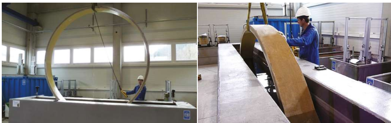
Acima: Ensaio de resistência à abrasão. Abaixo: Teste de rigidez circunferencial a longo prazo.
