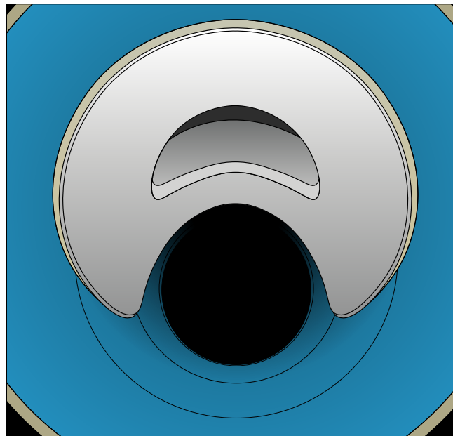
Fig. 60: Reparação das ligações laterais (LCR) com chapéu de reabilitação
