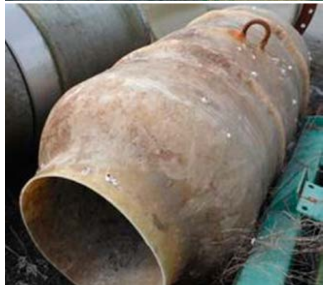
Ci-dessus: Après 33 ans en service dans l'eau de mer, une section du diffuseur en PRV a été ramené à terre pour analyse de ses propriétés mécaniques.
