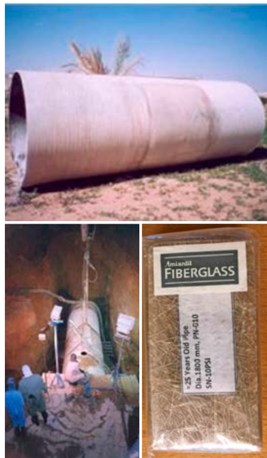
Fig. 9-11: Tuyau d'assainissement en PRV Flowtite DN 1800 déterré et inspecté après près de 25 années en service dans une station d'épuration à Riyad, Arabie Saoudite. Le tuyau ne montre aucun signe de détérioration.
