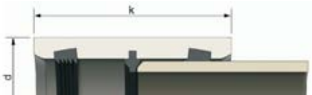
Nuotekoms skirtos FSC tipo DN300–1200 skersmens movos FLOWTITE
