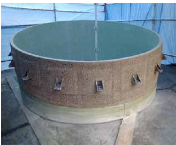
Fot. Przylaminowane łapy kotwiące na kształtce skośnej
